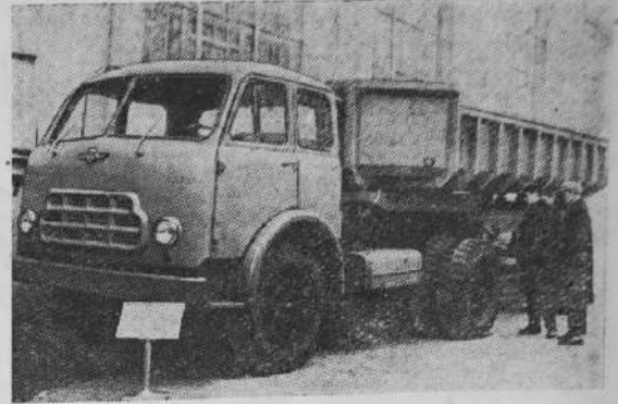
Москва. На Выставке достижений народного хозяйства СССР демонстрируется новый автомобильный тягач «МАЗ-504 Б» грузоподъемностью 12,5 тонны. Дизельный двигатель автомашины развивает мощность до 180 лошадиных сил, максимальная скорость 75 километров в час.
